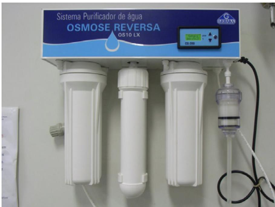
Figura 14 – Aparelho de destilação por osmose reversa.
